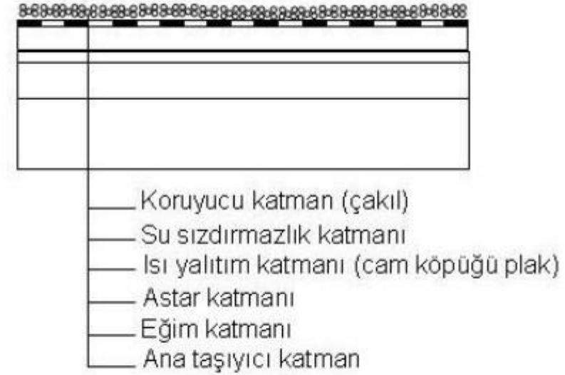
Şekil 7. Kompakt az eğimli sıcak çatı konstrüksiyonu [7]
