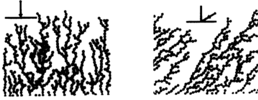
Şekil 20. Parçacıkların altlığa geliş açısına bağlı olarak gölgeleme etkisinin şematik gösterimi (Kranenburg ve Lodder, 1994).
