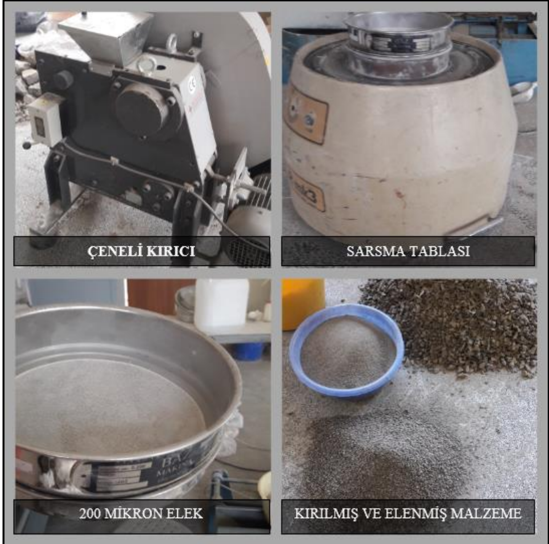
Şekil 8. Pirit, krom ve magnetit kayaçlarının çeneli kırıcıda kırılıp 200 nolu elekten elenmiş agrega görüntüsü
