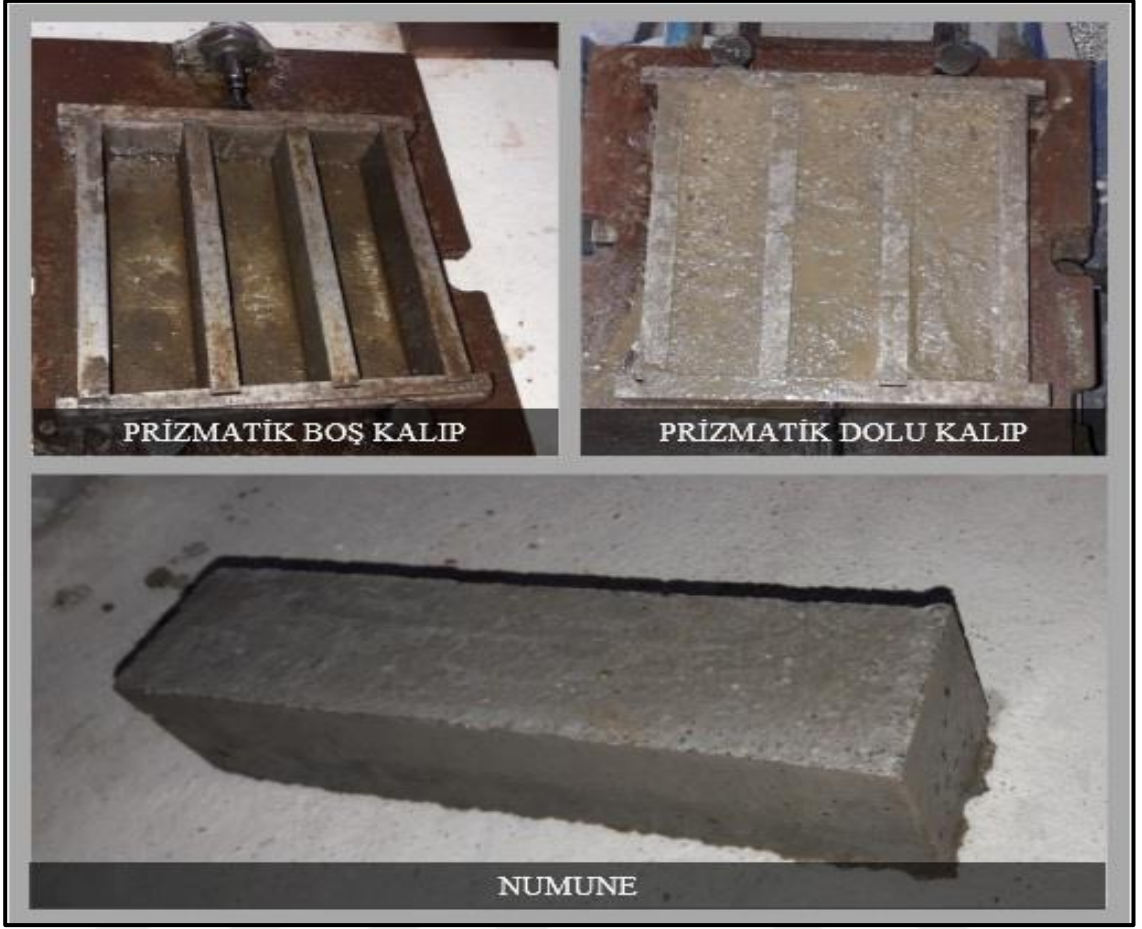
Şekil 11. 40x40x160 mm'lik ebadında prizmatik harç numuneleri.
