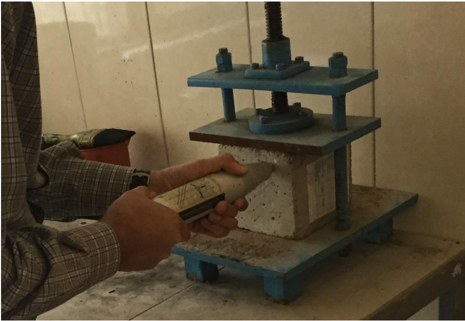
Şekil 15. Schimidt test çekici ölçümleri
