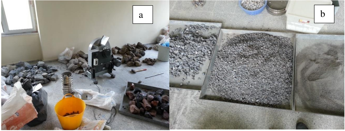
Şekil 7. (a) Araziden getirilen kayalar ve çeneli kırıcı (b) Çeneli kırıcılarda kırıldıktan sonra boyutlarına göre elenerek istiflenmiş agrega
