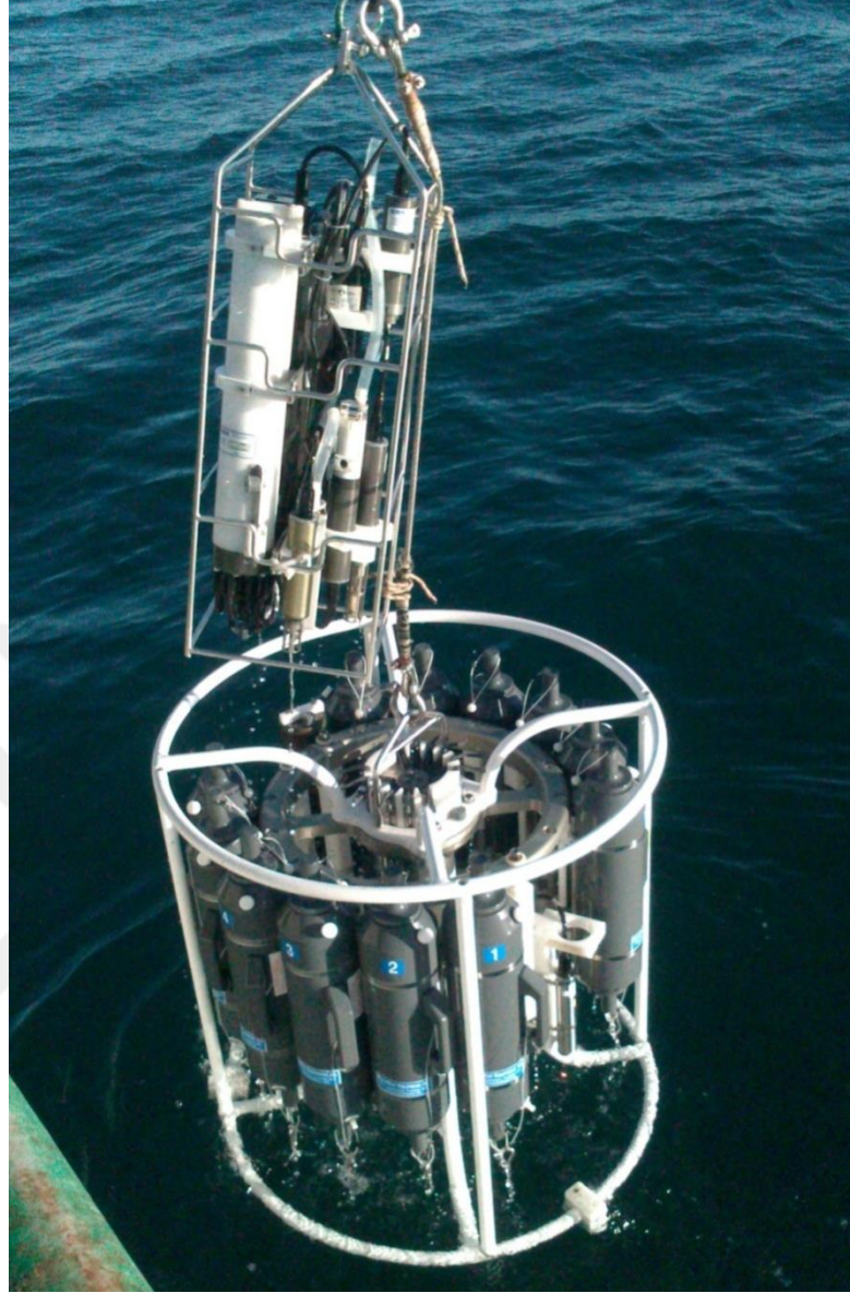
Şekil 3. Örneklemelerde kullanılan çoklu su örnekleyicisi ve CTD prob
