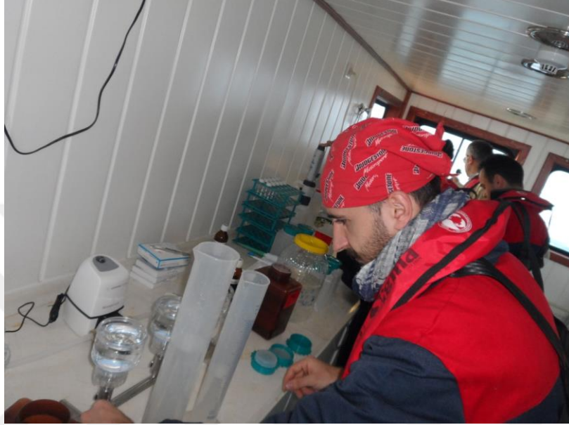
Şekil 4. HPLC analizleri için deniz suyu örneklerinin GF/F filtrelerden süzülmesi
