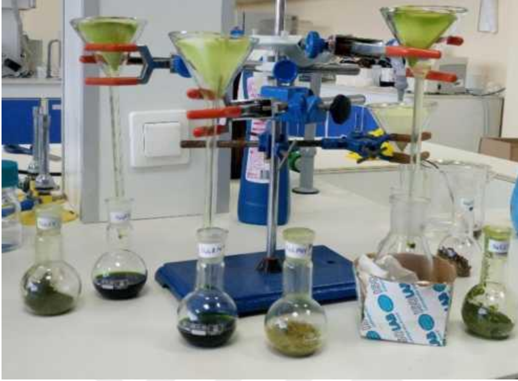
Şekil 14. Soldan başlayarak 1448Y, 1448MY,1453Y ve arkada 1448T ekstraktları süzme aşaması
