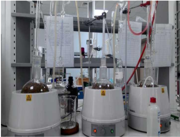
Şekil 13. Lamiaceae örnekleriyle yapılan su distilasyonu
