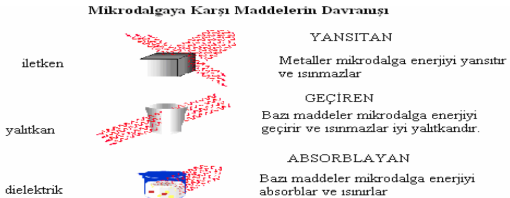
Şekil 3. Mikrodalğanın maddeler ile etkileşimi
