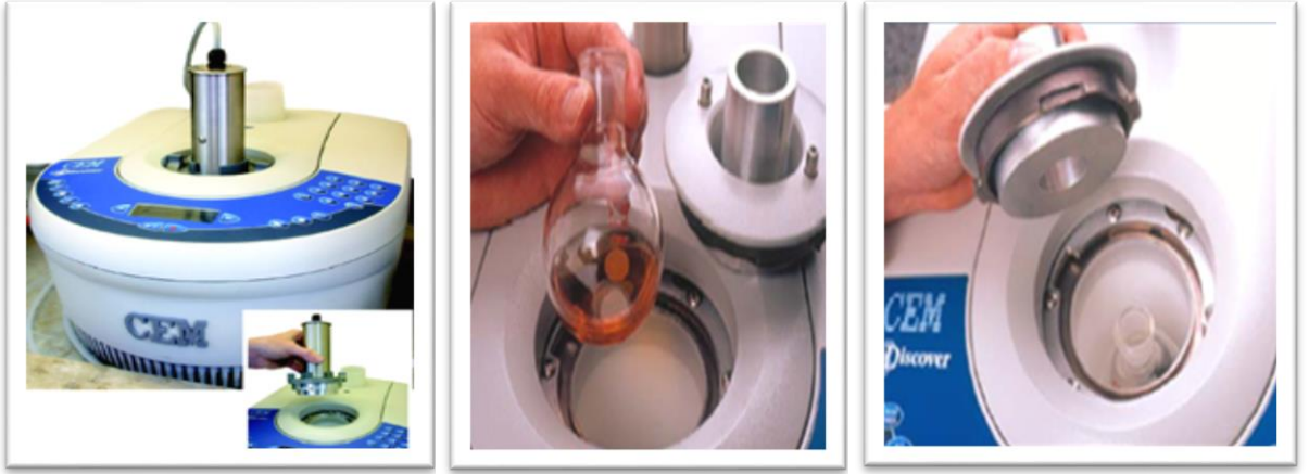
Şekil 9. Atmosferik şartlar ve kapalı basınç şartlarına göre sentez amaçlı üretilen bir tek-mod mikrodalga cihazı
