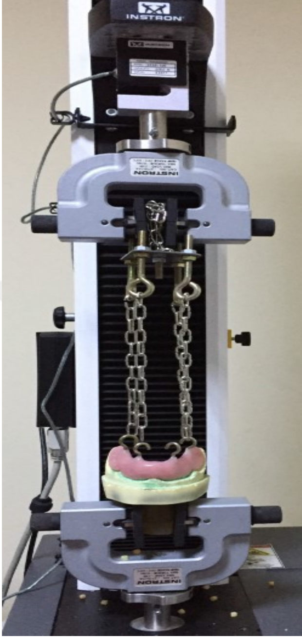
Şekil 3.10. Universal test makinesi ile overdenture protezin farklı tutucu sistemlerinin retansiyon değerlerinin ölçülmesi
