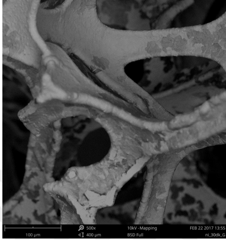
Şekil 27. Üzerinde 30 dk grafen büyütülmüş nikel köpük SEM görüntüsü
