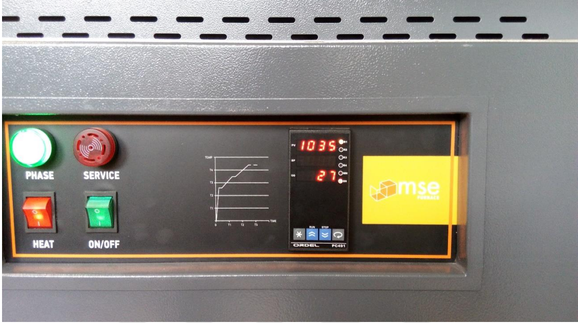
Şekil 12. CVD fırının ön yüzünde bulunan süreç kontrol cihazı
