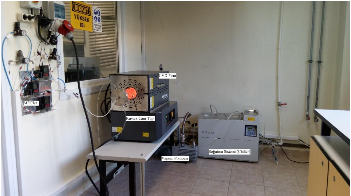
Şekil 11. TÜBİTAK MAM Enerji Enstitüsünde kurulan CVD sistemi
