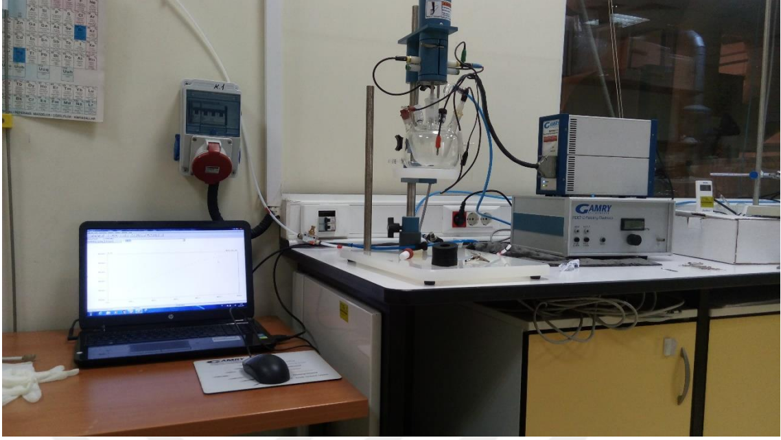
Şekil 19. GAMRY Reference 600 elektrokimyasal ölçüm sistemi donanımı
