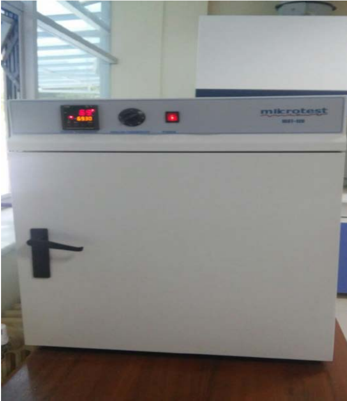
Şekil 16. Örneklerin kurutulmasında kullanılan etüv
