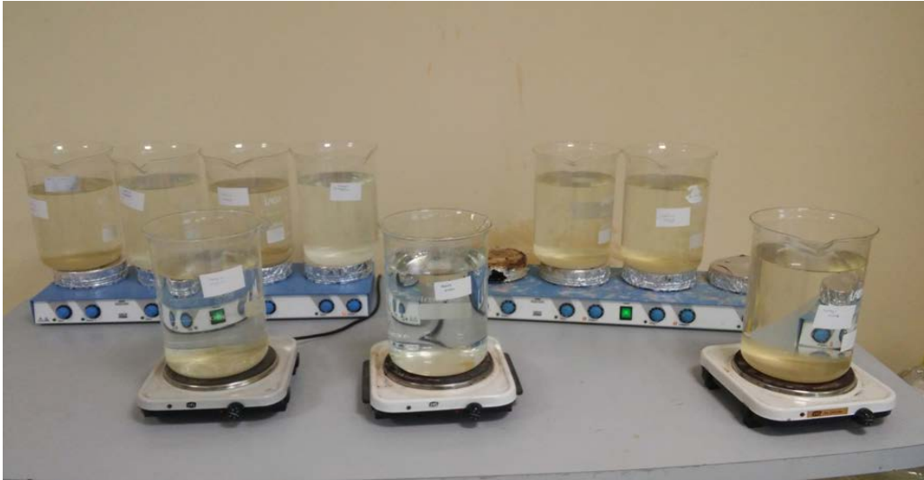
Şekil 10. Deniz suyu örneklerinin elektrikli ısıtıcılar üzerinde buharlaştırılması
