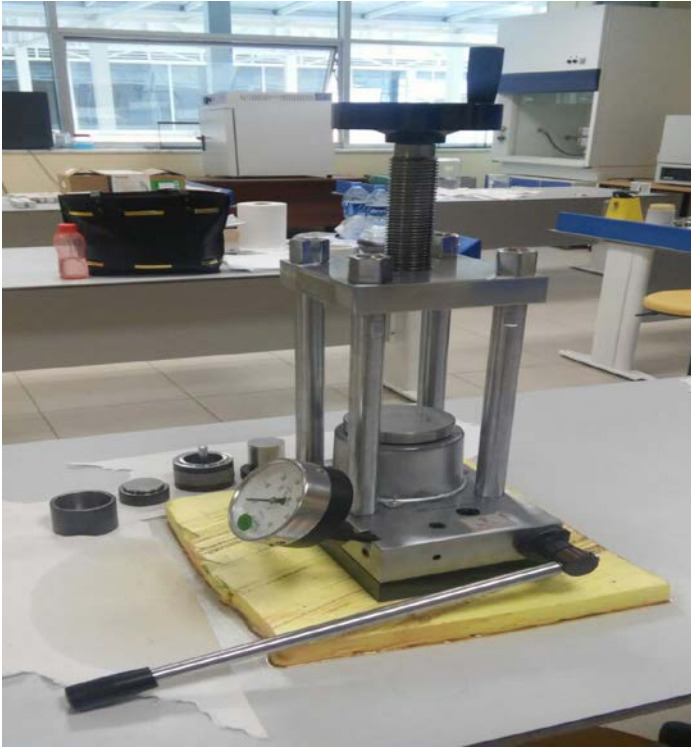
řekil 12. rneklerin pellet haline getirilmesinde kullanılan pres makinası
