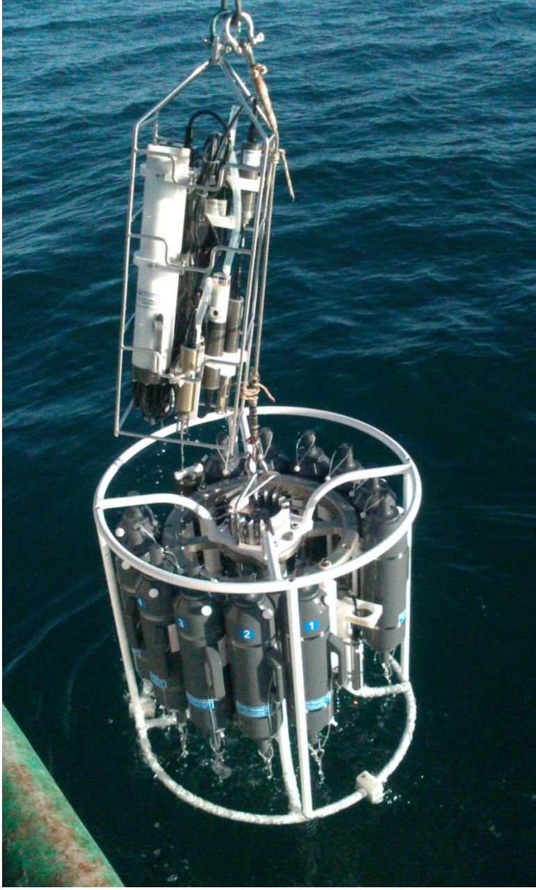
Şekil 2. SBE 25 CTD prob ve SBE 32 Carousel 12 şişeli su örnekleme cihazı
