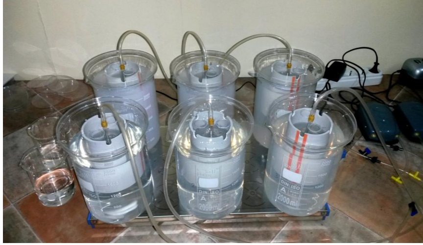
Şekil 7. Larvalara zarar vermeden dönme hareketi yaparak homojen bir nanopartikül karışım ortamı sağlayan yarı-izole toksikolojik test sistemi.
