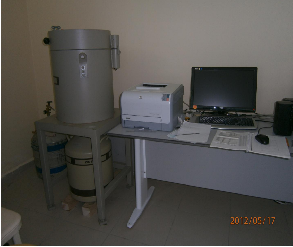
Şekil 2.1. Gama ışınları soğurma ölçümleri için kullanılan deney düzeneği
