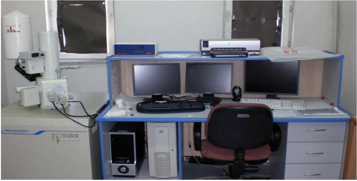
Şekil 33. JEOL JSM-6390L model taramalı elektron mikroskobu.
