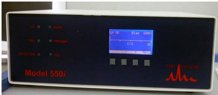
Şekil 34. EDS2006 Model 550i IXRF System isimli EDS cihazı
