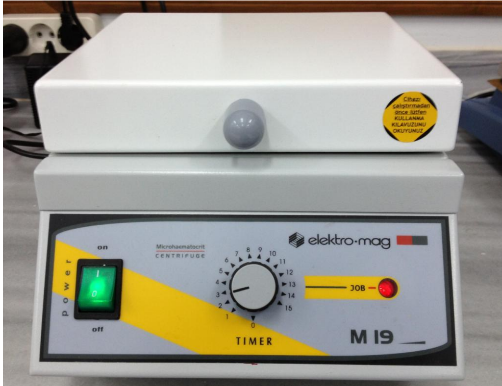
Şekil 13. Spermatokrit oranının belirlenmesinde kullanılan Elektro-mag santrifüj cihazı.
