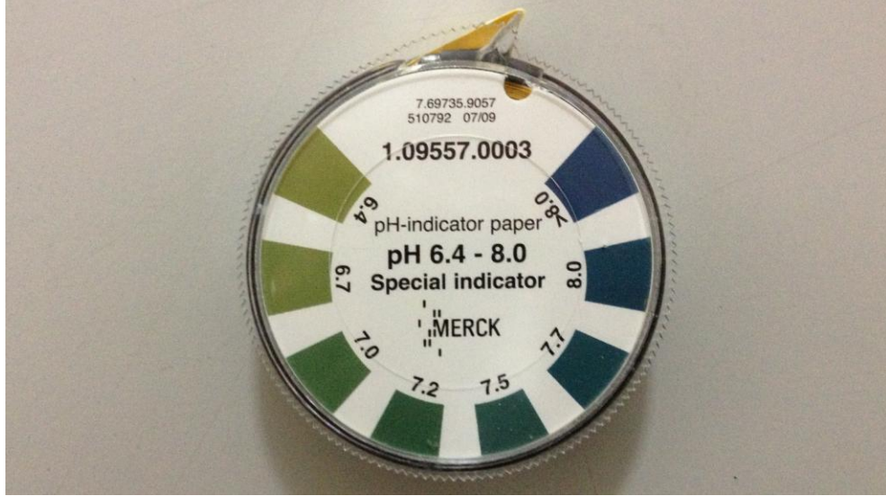
Şekil 14. Sperma pH'sının belirlenmesinde kullanılan Merc 6,4-8,0 pH indikatör kâğıdı.
