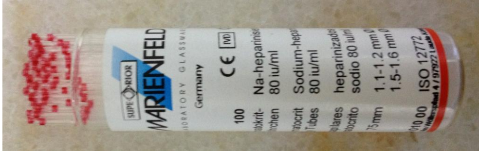
Şekil 12. Spermatokrit oranının belirlenmesinde kullanılan heparinli mikrohematokrit kapillar tüpler.
