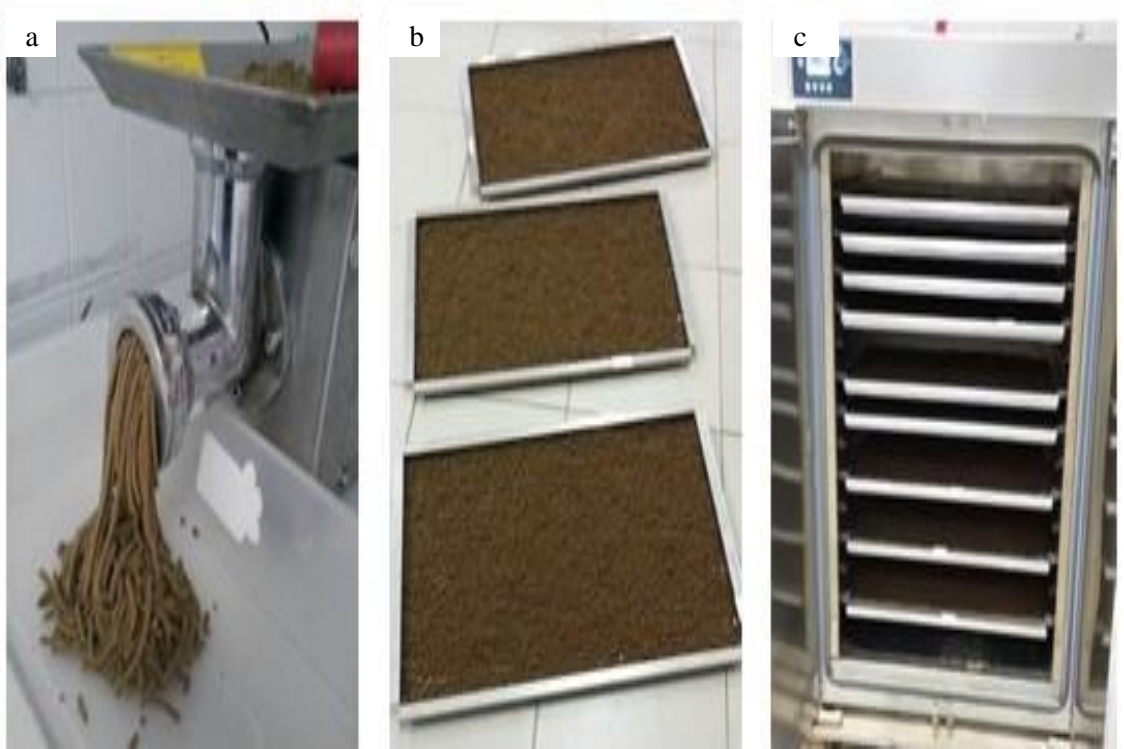
Şekil 10. Yemin peletleme aşamaları (a- peletlerin oluşturulması, b- kurutma tepşilerine yerleştirme, c- kurutma dolabında kurutma işlemi) (Orijinal).
