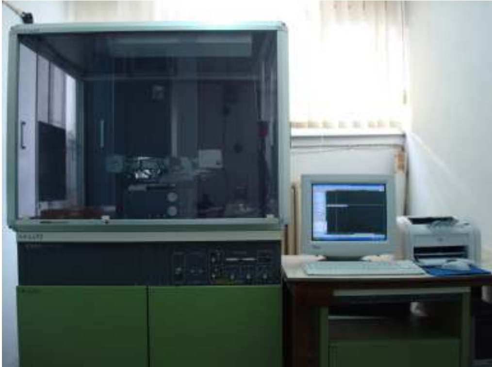
Şekil 14. X-ışını difraktometresi (Rigaku D/Max-IIIC)
