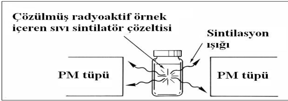
Şekil 13. Beta aktif maddenin sintilasyon ve dedeksiyon mekanizması
