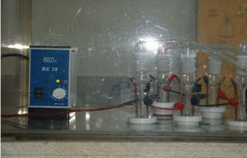
Şekil 26. Elektroliz banyosu – karıştırıcı, Hücre bağlantıları, Atık gaz çıkışı bağlantıları
