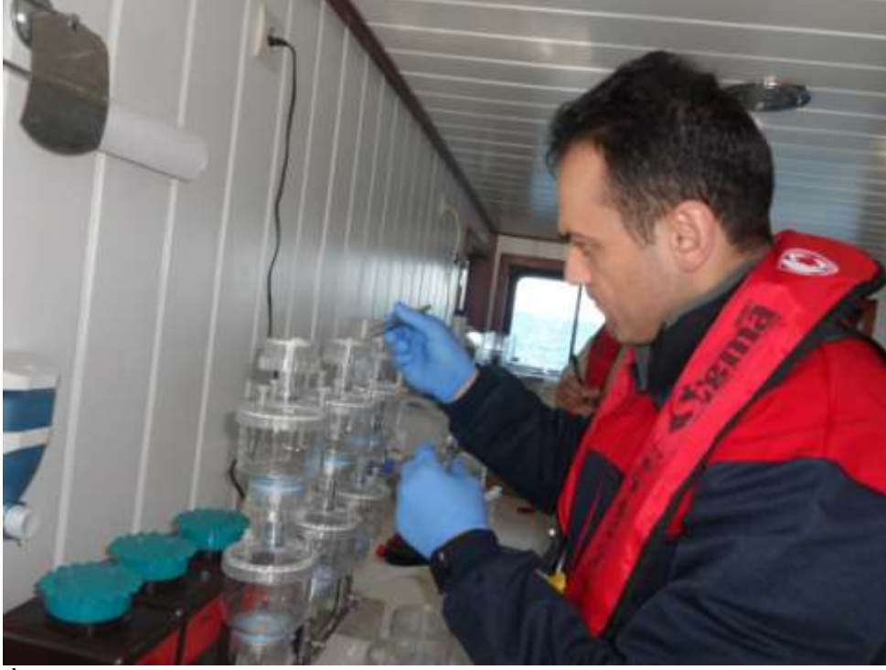
Şekil 6. İnbüasyon sonrası örneklerin farklı göz açıklığındaki filtrelerden süzülmesi
