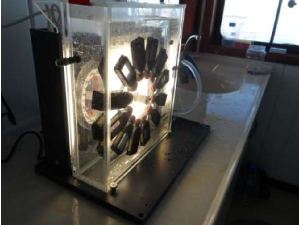
Şekil 5. C-14 inkübatöründe örneklerin inkübasyon aşaması
