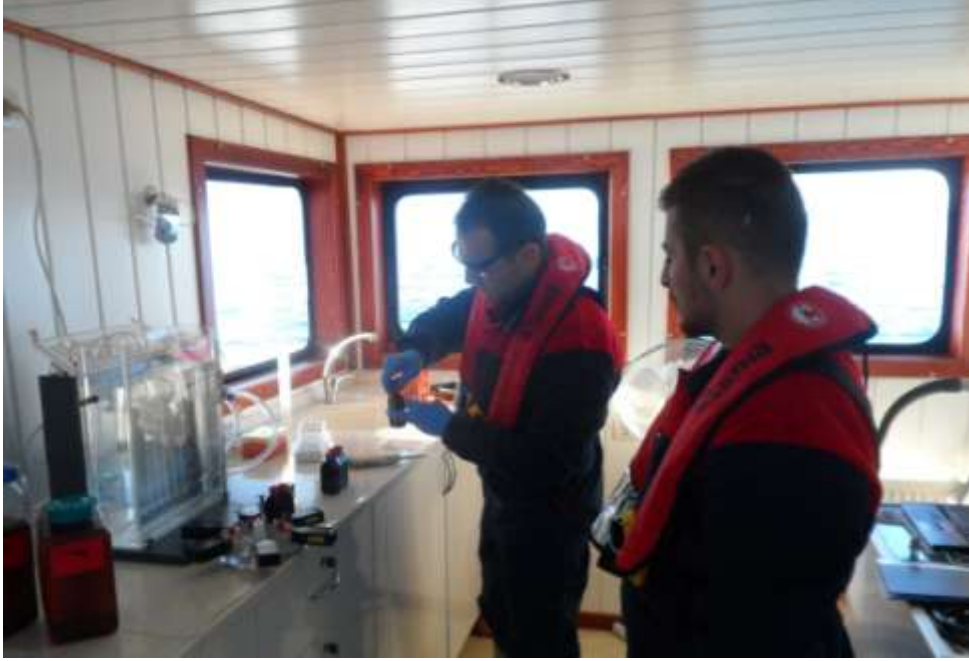
Şekil 3. Deniz suyu örneklerine C-14 standartlarının ilave edilmesi
