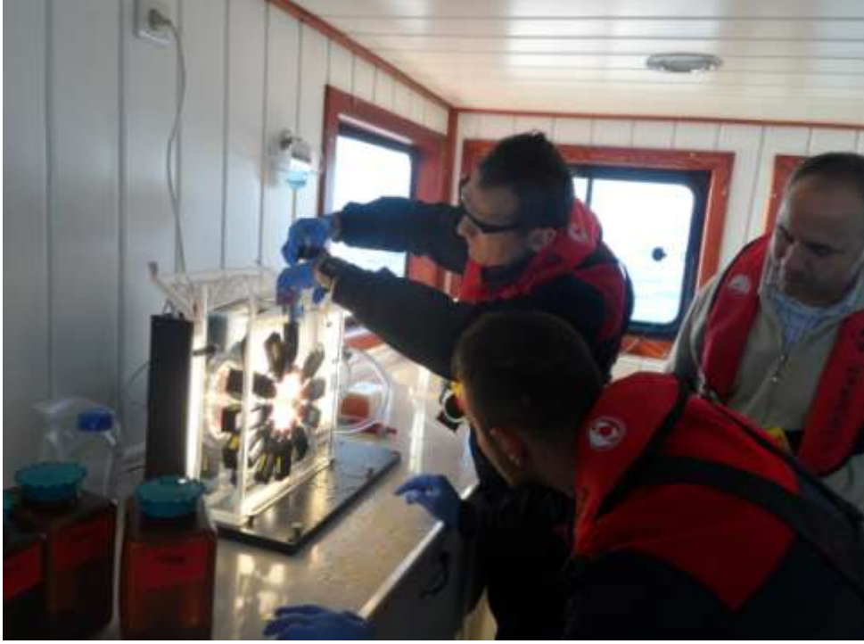
Şekil 4. C-14 standartları ilave edilen örneklerin ICES C-14 inkübatörüne yerleştirilmesi
