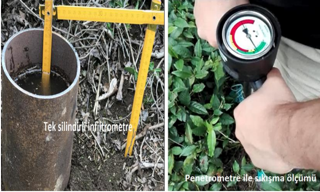
Şekil 2. Arazide toprak sıkışması ve infiltrasyon ölçümünün yapılması (Foto: Yüksek, 2017).
