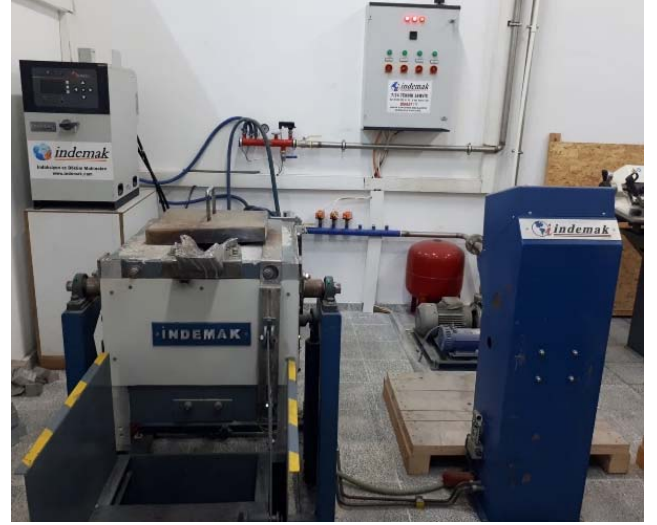
Şekil 1. Çalışmada kullanılan döküm ocağının fotoğrafı (A photograph of the induction casting furnace used in the study)
