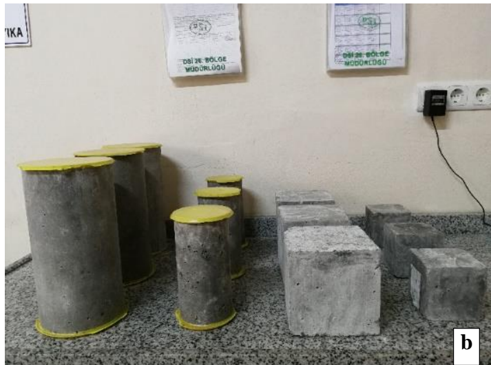
Şekil 12. (a) Kütle betonlardan alınan silindir numuneler (b) Basınç deneyi öncesi kükürtle başlık yapılmış silindir numuneler ve küp numuneler
