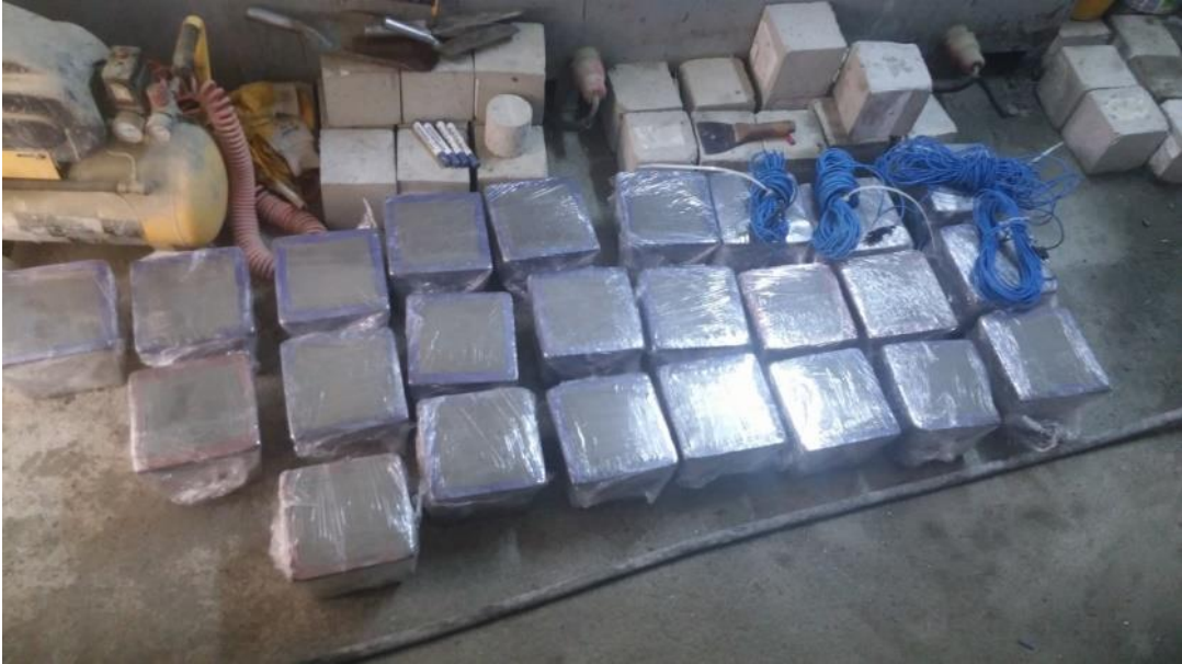
Şekil 15. Taze betondan alınan küp numunelerin streç film ile sarılması
