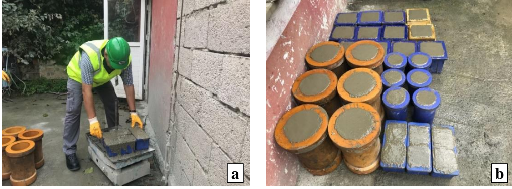
Şekil 9. (a) Taze betonların kalıbına yerleştirilmesi, (b) Farklı biçim ve boyutlardan alınan beton numuneleri
