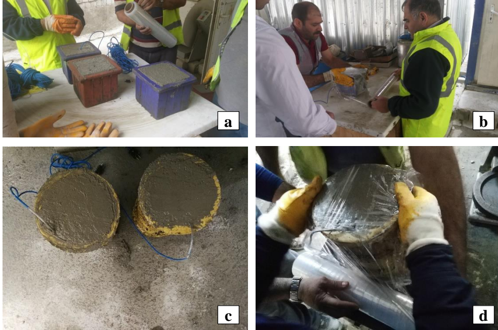
Şekil 22. (a) 15 cm'lik küp beton numuneleri, (b) 15 cm'lik küp beton numunelerinin streç ile sarılması, (c) Sıcaklık sensör kablosu yerleştirilmiş silindir numuneler, (d) Sıcaklık sensör kablosu konulduktan sonra numunenin streç ile sarılması
