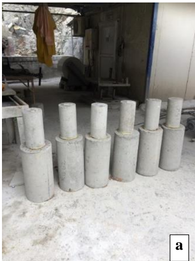
Şekil 12. (a) Kütle betonlardan alınan silindir numuneler (b) Basınç deneyi öncesi kükürtle başlık yapılmış silindir numuneler ve küp numuneler
