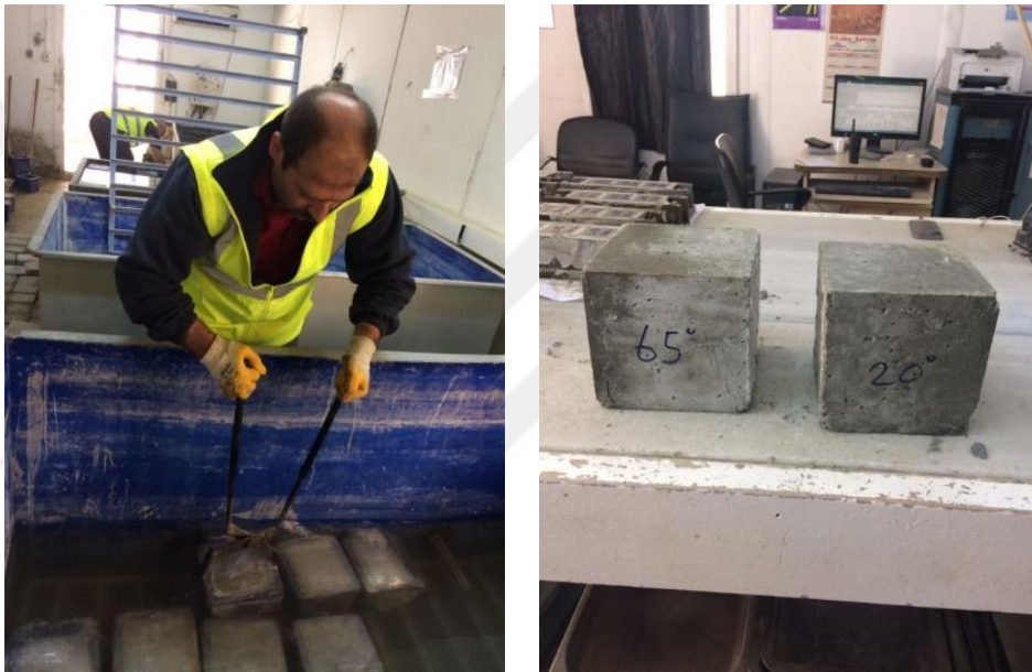
Şekil 18. 20°C ve 65°C kür havuzundan çıkartılan beton numuneler
