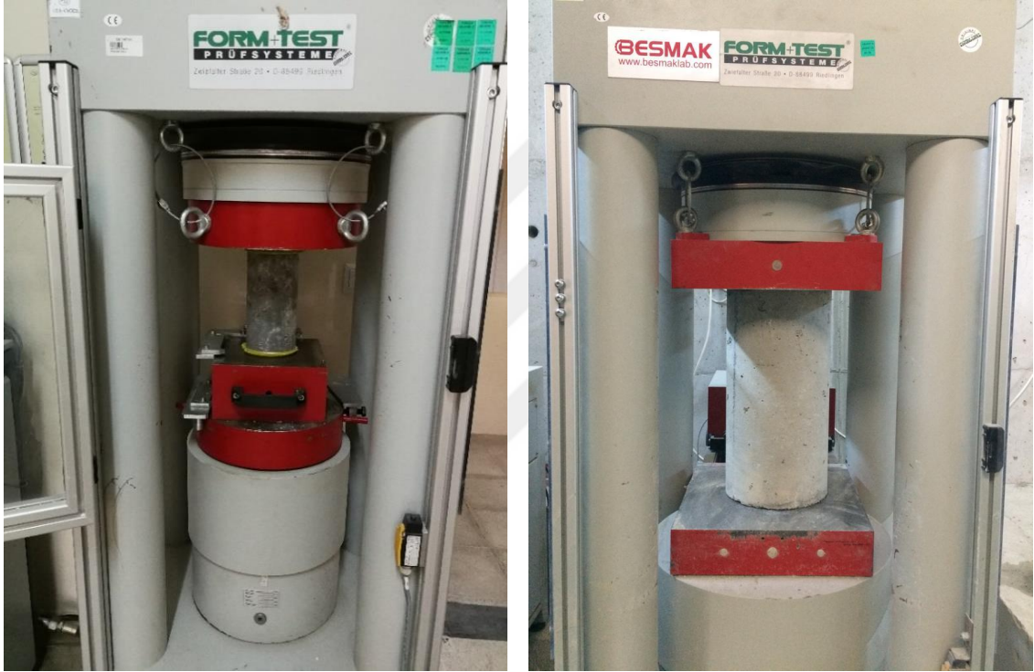
Şekil 13. 2000 kN ve 5000 kN kapasiteye sahip beton presleri
