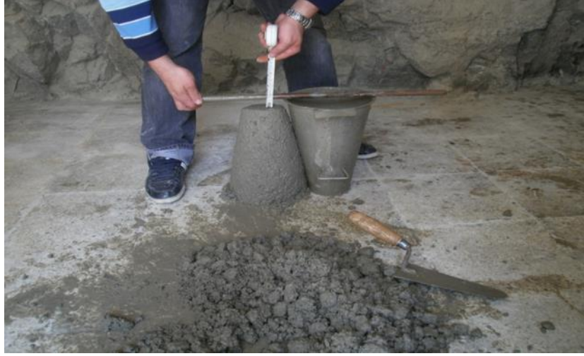
Şekil 8. Kütle betonunda ıslak elemenden sonra alınan betonda çökme deneyi uygulaması
