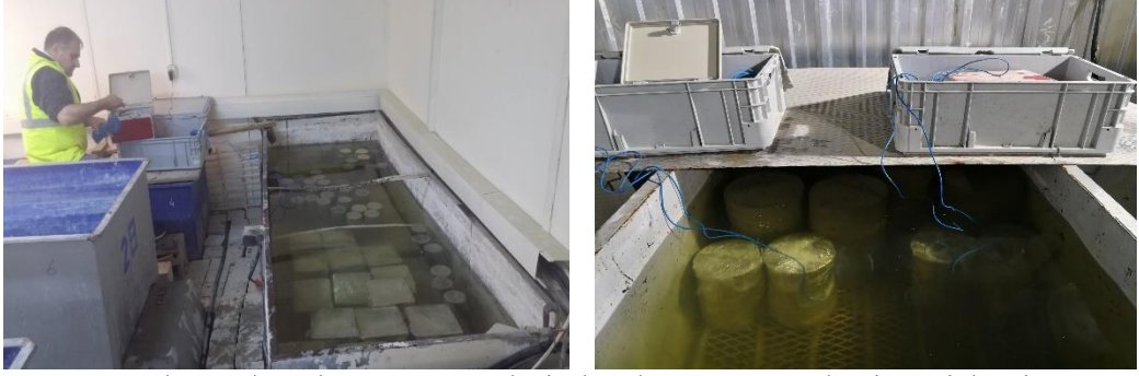
Şekil 23. Taze betondan alınan numunelerin kür havuzuna yerleştirme işlemi
