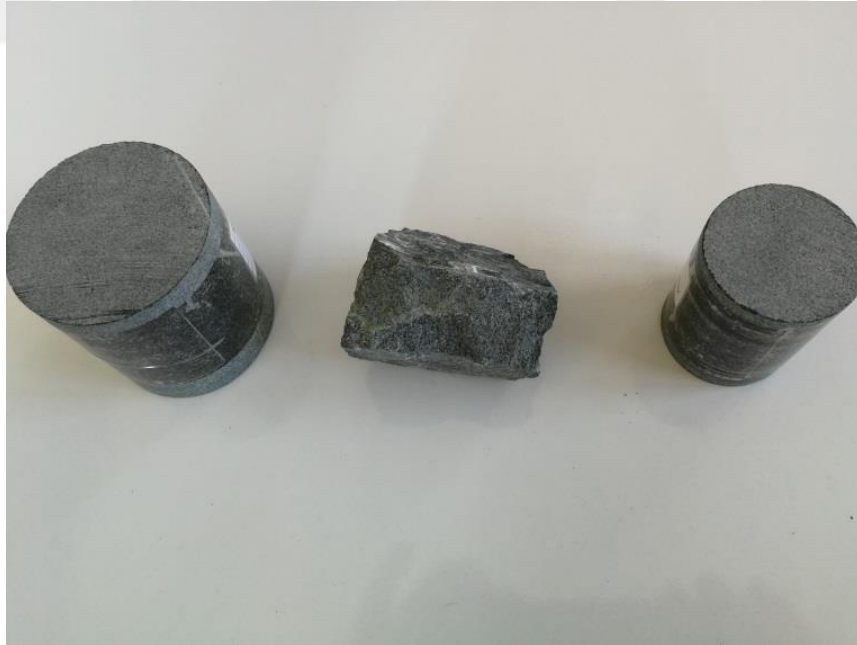
Şekil 3. Granit esaslı kırmataş ve granitten alınan karot örnekleri
