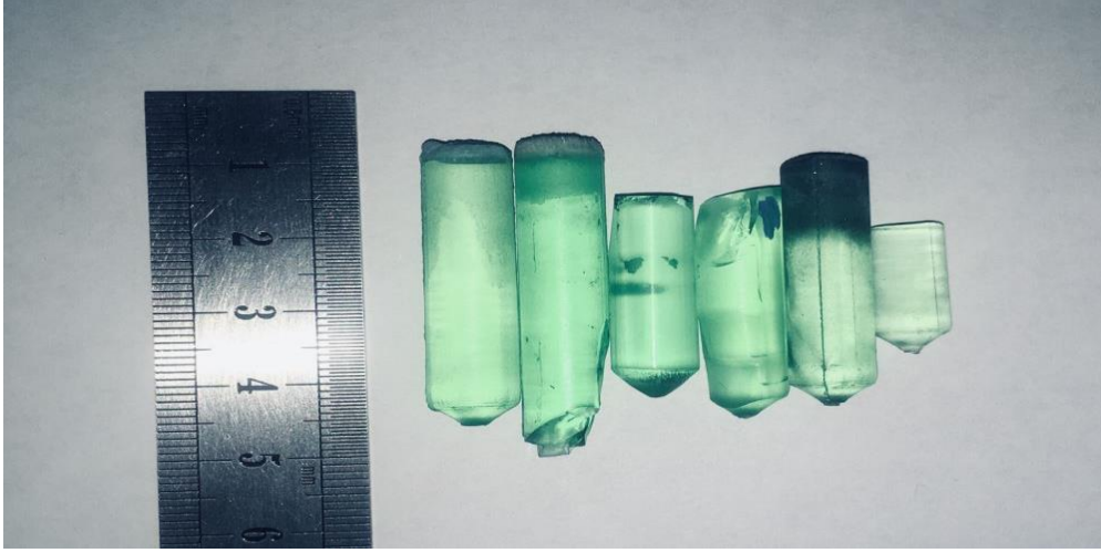
Şekil 2. 6 Farklı fiziksel özelliklerdeki Cr:LiCAF kristal tedarik talebi ve yurtdışında üretilen ham kristal yapılar
