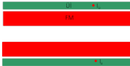
Şekil 26. Hesaplamalarda kullanılan geometri. I_a alttan geçen akımı I_{\dot{u}} ise üstteki iletkenlerden geçen akımı göstermektedir.
