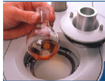
Şekil 1. 15. Atmosferik şartlar ve kapalı basınç şartlarına göre sentez amaçlı üretilen bir tek-mod mikrodalga cihazı
