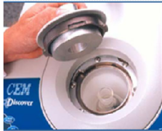
Şekil 1. 15. Atmosferik şartlar ve kapalı basınç şartlarına göre sentez amaçlı üretilen bir tek-mod mikrodalga cihazı
