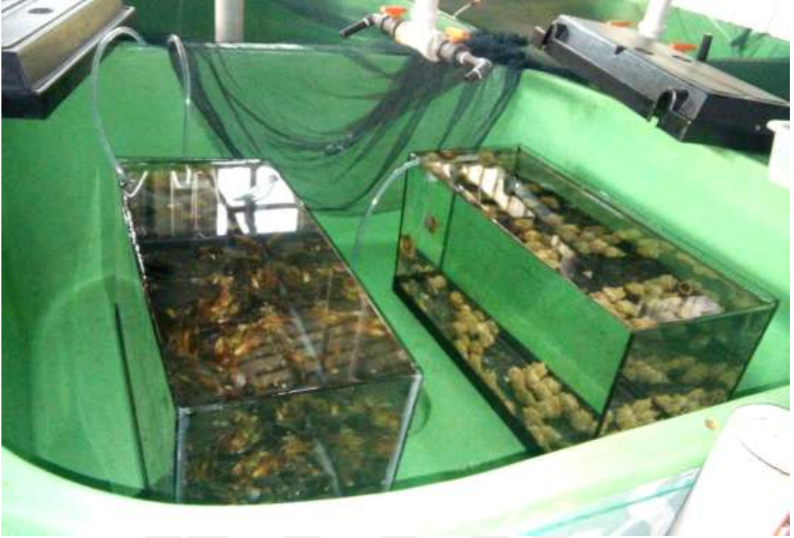
Şekil 16. Temiz deniz suyu akarsu sisteminde midye ve deniz salyangozu örnekleri için atılım deneyi.
