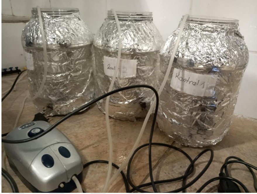
Şekil 3. Işık geçirgenliğini engellemek ve stresi en aza indirmek amacıyla alüminyum folyo ile kaplanmış tanklar
