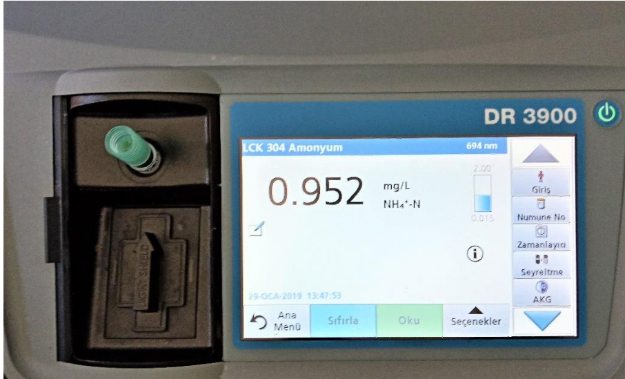
Şekil 4. Suyun amonyak değerinin ölçülmesinde kullanılan spektrofotometre
