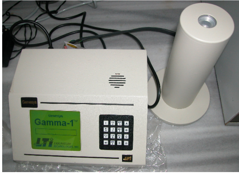
Şekil 12. Kortizol ölçümünde kullanılan Gamma 1 Counter cihazı.
