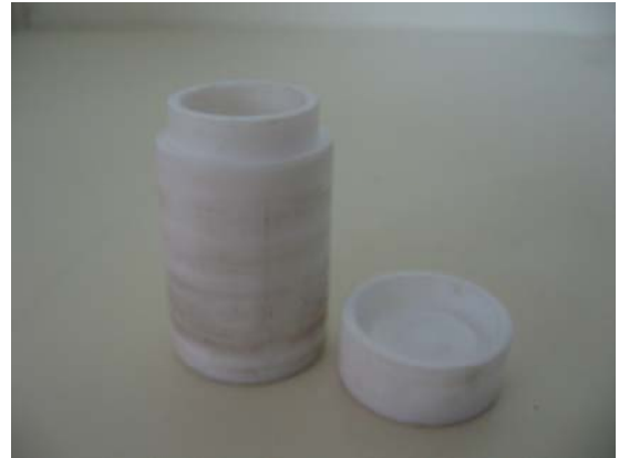
Şekil 1. Hidrotermik yöntemle madde sentezi için kullandığımız reaktör
