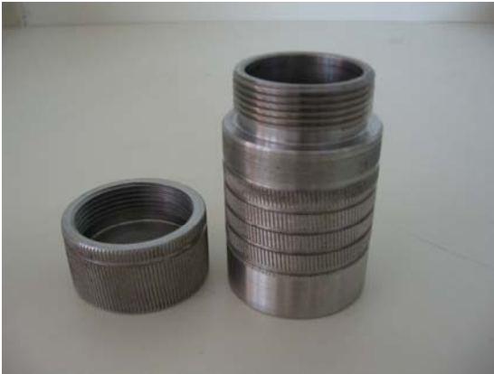
Şekil 1. Hidrotermik yöntemle madde sentezi için kullandığımız reaktör
