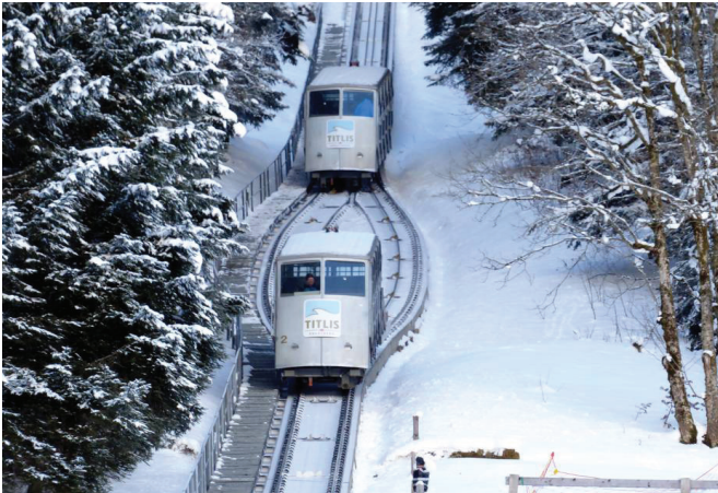
Fotoğraf 2: Orta İsviçre'de 3.238 m rakımlı Titlis dağı turizm destinasyonunda dört mevsim ulaşım hizmeti sunan füniküler hattı. Aynı rakımda füniküler hatları, teleferik sistemlerine göre daha güvenilir olmaları nedeniyle tercih edilmektedir. 9
