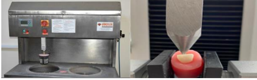
Şekil 4. Kuronlara uygulanan termal yaşlandırma işlemi sonrası kırılma dayanım testinin uygulanması
