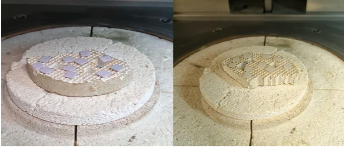
Şekil 2. Fırına yerleştirilen IPS e.max CAD ve IPS Empress CAD örnekler
