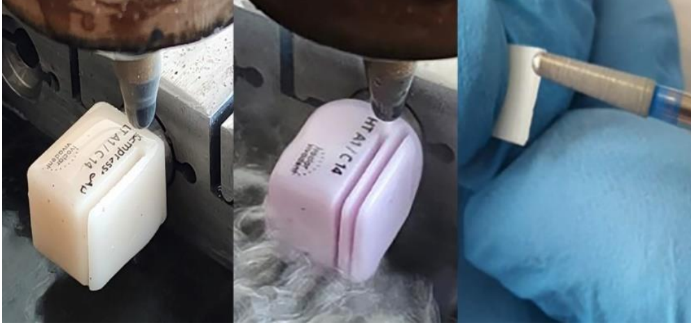
Şekil 1. IPS Empress ve IPS e.max CAD blokların su jet cihazı ile kesimi ve örneklerin düzensizliklerinin giderilmesi
