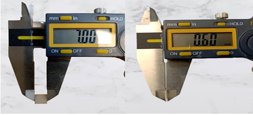
Şekil 3. Hazırlanan örneklerin boyutlarının dijital kumpas yardımıyla kontrol edilmesi
