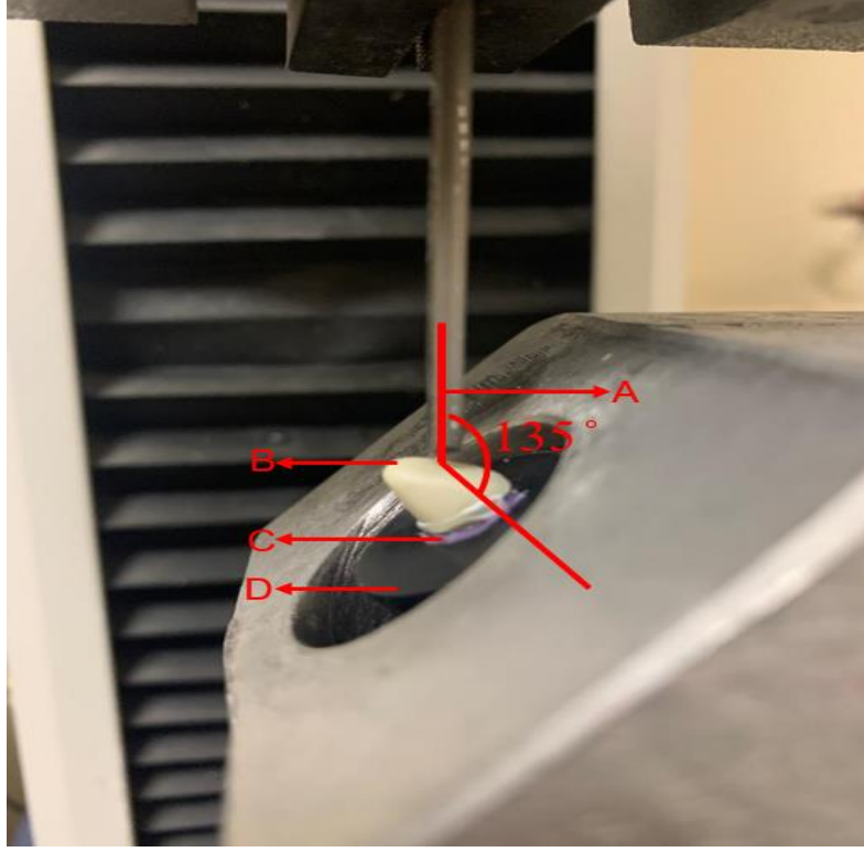
Şekil 4. Kırılma dayanım testi düzeneği
