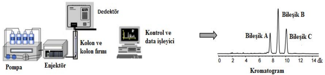
Şekil 17. HPLC cihazının şematik gösterimi (URL-2, 2017)
