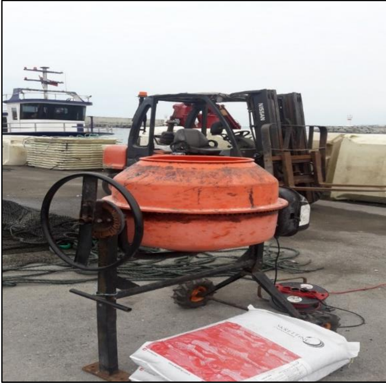
Şekil 14. Yeme ilaç veya vitamin karıştırma amacıyla kullanılan karma makinesi.
