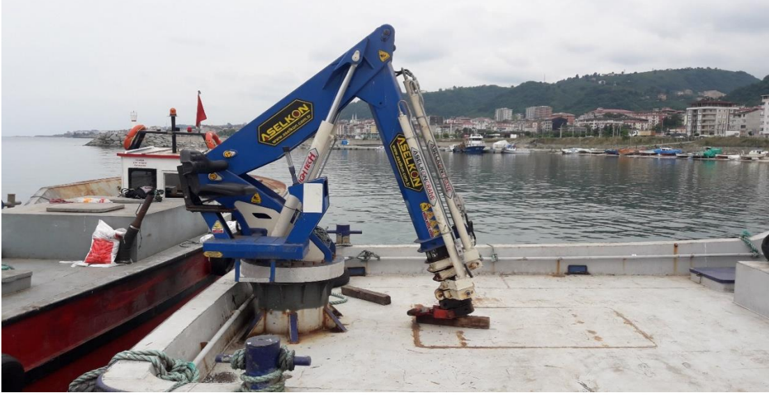
Şekil 7. Ağ deęişimde, balık naklinde ve yem transferinde kullanılan tekne üzeri vinci yapısı.
