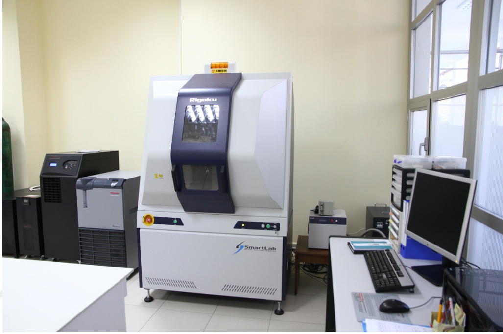
Şekil 29. Rigaku marka SmartLab X-ışını difraktometresi
