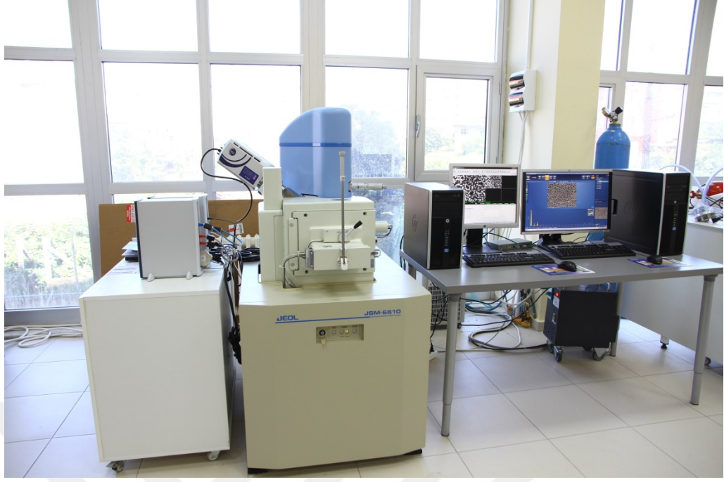
Şekil 31. JEOL marka JSM-6610 model taramalı elektron mikroskobu
