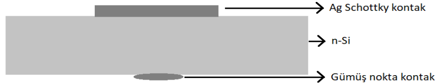
Şekil 27. Oluşturulan Schottky diyotun şematik görünümü
