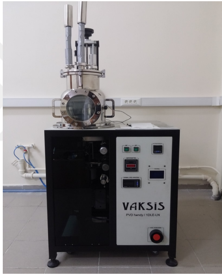
Şekil 25. VAKSİS PVD handy/1DLE-LN marka termal buharlaştırma sistemi
