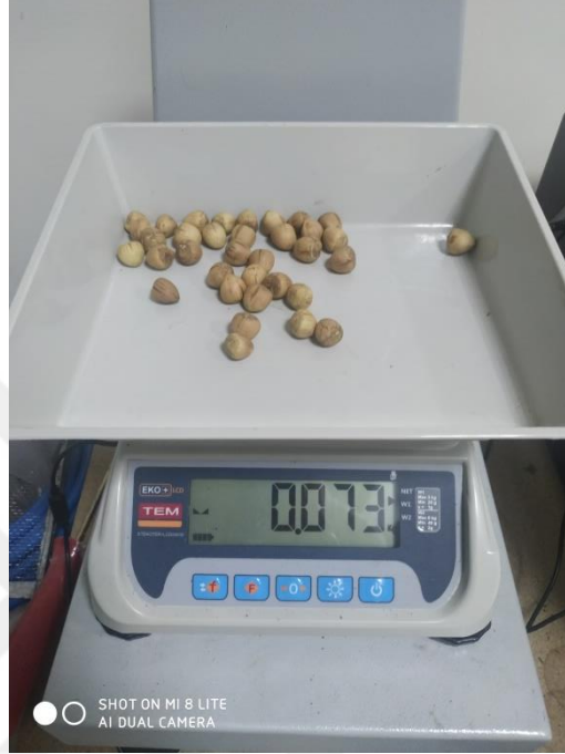
Şekil 28. Üçüncü deney sonrası gözlemlenen kütle değişimi.
