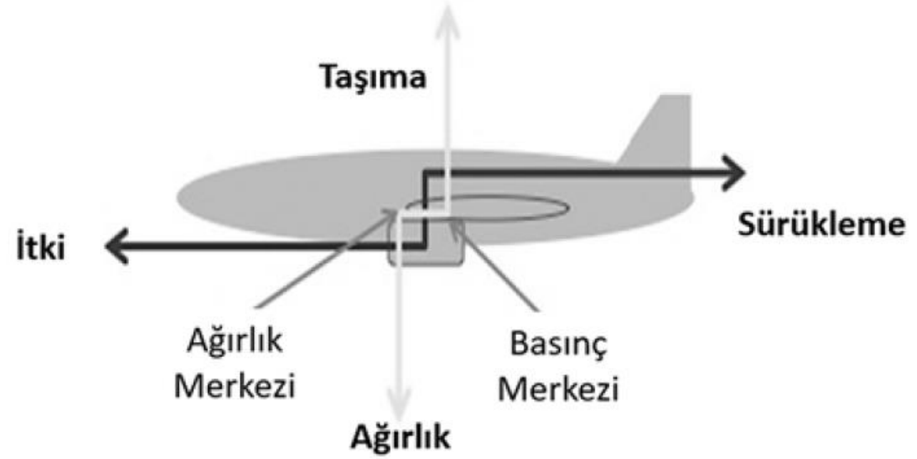
4 Kuvvetin Aerodinamik Gösterimi
