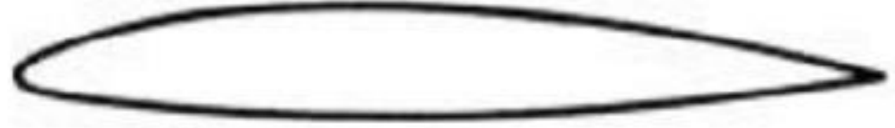
Laminer Akış Kanat Profili (Sesaltı Uçuşlar İçin)
