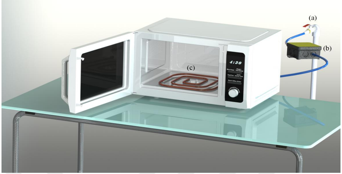
Şekil 2. Deney düzeneğinin katı modelleme programında çizilmiş hali (a) Hava tesisatı, (b) Girişteki havanın sıcaklık ve nem ölçüm kutusu, (c) Dönmeli akışı oluşturan hava delikli ve özel tasarımlı bakır hava borusu
