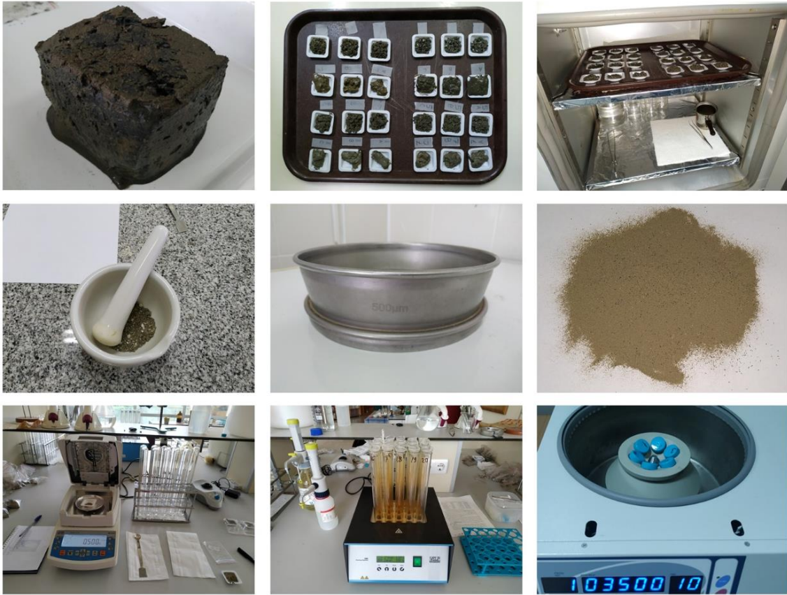
Şekil 8. Metal analizi için sediment örneklerinin hazırlanması
