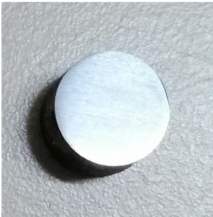
Şekil 13. Yüzey parlatma işleminden sonra korozyon deneyine hazır hale getirilen numune.
