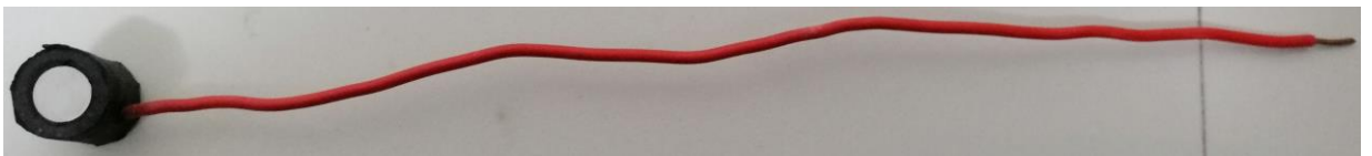
Şekil 15. Anot olarak kullanılan çelik donatı numuneleri.
