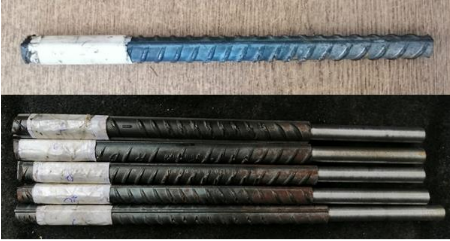
Şekil 11. Çelik donatıların tornada sıyrılmış ve sıyrılmamış durumları.
